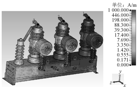
(a) 柱上开关磁场分布图
